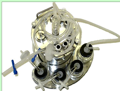
酸・アルカリ・消泡剤・排気バブラー 瓶を装着したまま滅菌可能
